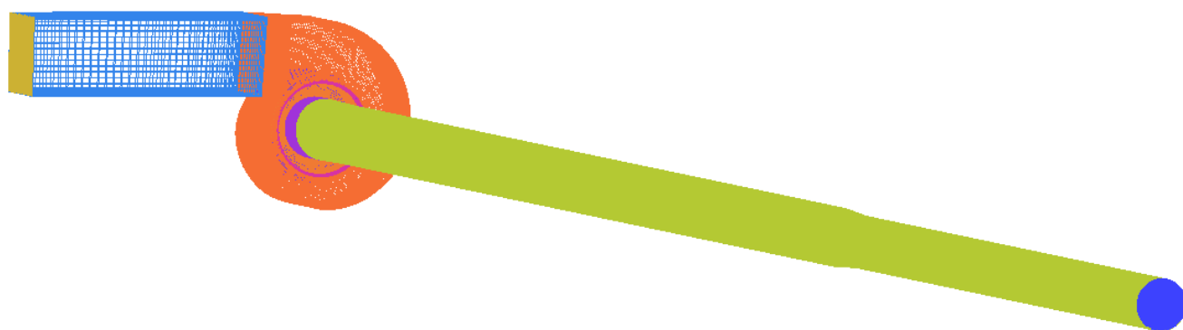
图 3.13 蜗壳部分（含入口与部分出口）网格
