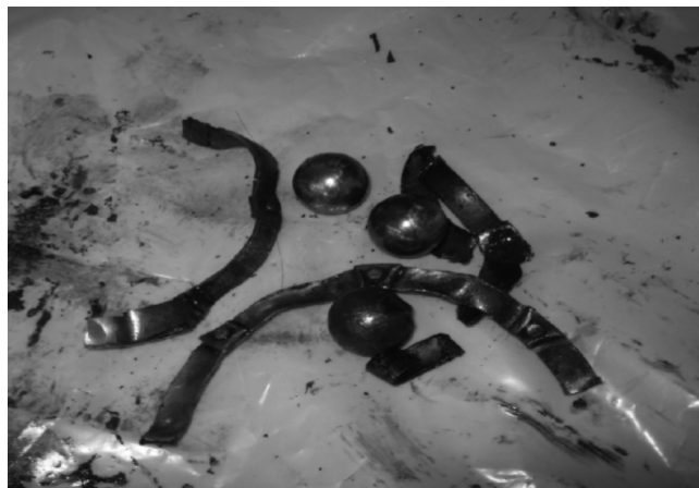
图 2 轴承保持架弯曲断裂、滚动体脱离滚道
